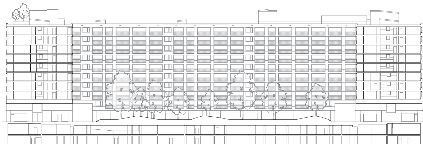
Coupe longitudinale : deux niveaux de parkings occupent l'emprise de la parcelle. Dans la cour, la végétation est plantée sur une butte qui fournit une épaisseur de terre suffisante.
